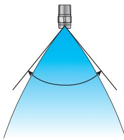
与喷量一样，喷角也以常温净水为标准在各喷嘴系列设定的标准压力下，保证喷角公差在±5°以内。喷嘴的喷角如无特殊提示，则表示为喷嘴近傍的角度。
