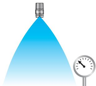
本目录记载的喷量以常温、净水为标准，在各喷嘴系列设定的标准压力下，保证喷量公差在±5%以内。
